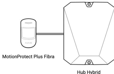
MotionProtect Plus Fibra est un détecteur de mouvement filaire avec un capteur de micro-ondes K-band supplémentaire.
