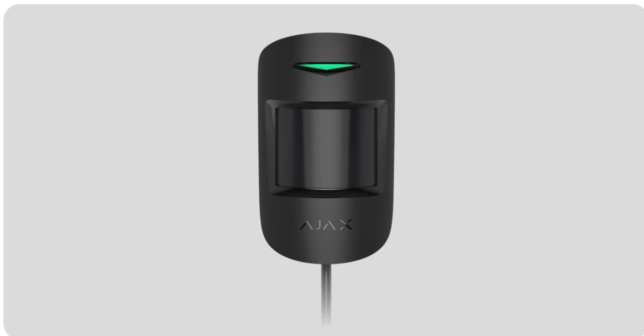
**MotionProtect Plus Fibra** est un détecteur de mouvement filaire avec un capteur à micro-ondes K-band supplémentaire. Le détecteur peut détecter les mouvements à une distance allant jusqu'à 12 mètres. Avec le capteur infrarouge, il applique un balayage par radiofréquence qui filtre les interférences thermiques. Ne réagit pas aux animaux de compagnie jusqu'à 50 centimètres de hauteur et pesant jusqu'à 20 kilogrammes. Pour une installation intérieure.
